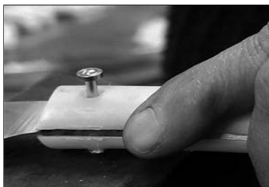
Coltello forzato eccessivamente applicando torsione o flessione
