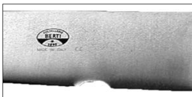
Rottura lama forzata a leva
