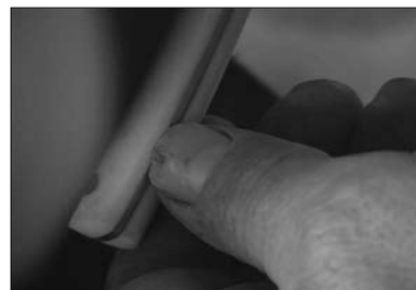
Rottura lama forzata a leva
