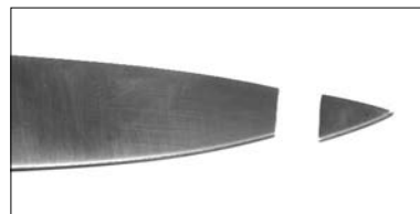
Rottura lama forzata a leva
