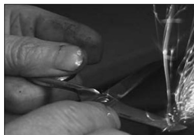
Coltello forzato eccessivamente applicando torsione o flessione
