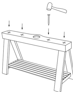
2. Forare la barra in ceramica con punteruolo e martello, per installare gli accessori.
