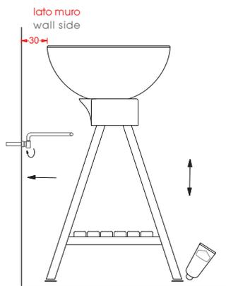
5. Installare i rubinetti in squadra sull'impianto idrico; Applicare l'adesivo in dotazione sotto i piedi del cavalletto e posizionare la struttura nel punto desiderato. **ATTENZIONE:** la parete curva della barra va rivolta verso il muro.
