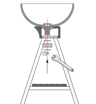
4. Nella parte sottostante della struttura, interporre il distanziatore inox tra la guarnizione ed il dado della piletta. Serrare energicamente.
